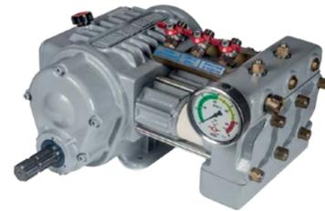
Bomba reductora Mañez&Lozano, especialmente diseñada para atomizadores. De bajo mantenimiento y gran durabilidad, esta bomba incorpora un eje reductor y un eje pasante: el eje pasante permite transmitir directamente las revoluciones de la toma de fuerza del tractor al grupo de aire, y la reductora disminuye las revoluciones del cigüeñal de la bomba reduciendo la absorción de potencia, el consumo de combustible y el desgaste de la misma.
