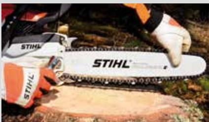
**Garras.** Situadas en la parte frontal junto a la espada, facilitan el corte clavándolas sobre la madera y al pendular sobre este punto se reduce el esfuerzo de trabajo.
