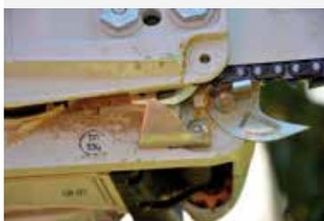
**Retenedor de cadena o perno guardacadenas.** En el caso de una rotura de cadena o de que ésta se salga de la espada, parte de la misma se enrollaría en el retenedor de cadena para evitar que golpee al operario. Suele ser una pieza de material más blando que la propia cadena para evitar que ésta se dañe.
