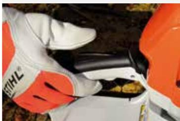
**Bloqueo del acelerador.** Dispositivo que impide accionar el acelerador involuntariamente y, por tanto, una puesta en marcha no deseada de la cadena.
