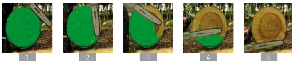
Si el fuste se apoya sobre dos puntos y tenemos que cortar entre ambos, se cortará, como norma general, de abajo (zona de tensión) hacia arriba (zona de presión); se recomienda dar un pequeño corte inicial de descarga por arriba.
