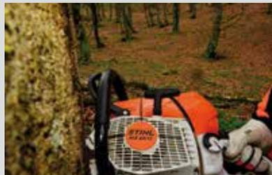
**Línea de referencia para el apeo.** Situada en el contorno de la máquina a 90° respecto de la espada. Ayuda a realizar los cortes de dirección correctamente orientados en la dirección de caída deseada del árbol.
