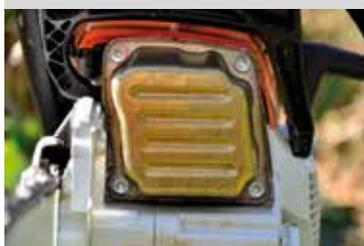
**Escape.** Canaliza los gases quemados hacia el exterior en dirección contraria al operario y reduce el nivel sonoro producido por el motor. Debe estar alejado del usuario para protegerlo de posibles quemaduras.
