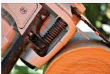
**Sistema Antivibración.** Conjunto de elementos que reducen la transmisión de vibraciones del motor y el equipo de corte a las empuñaduras.
