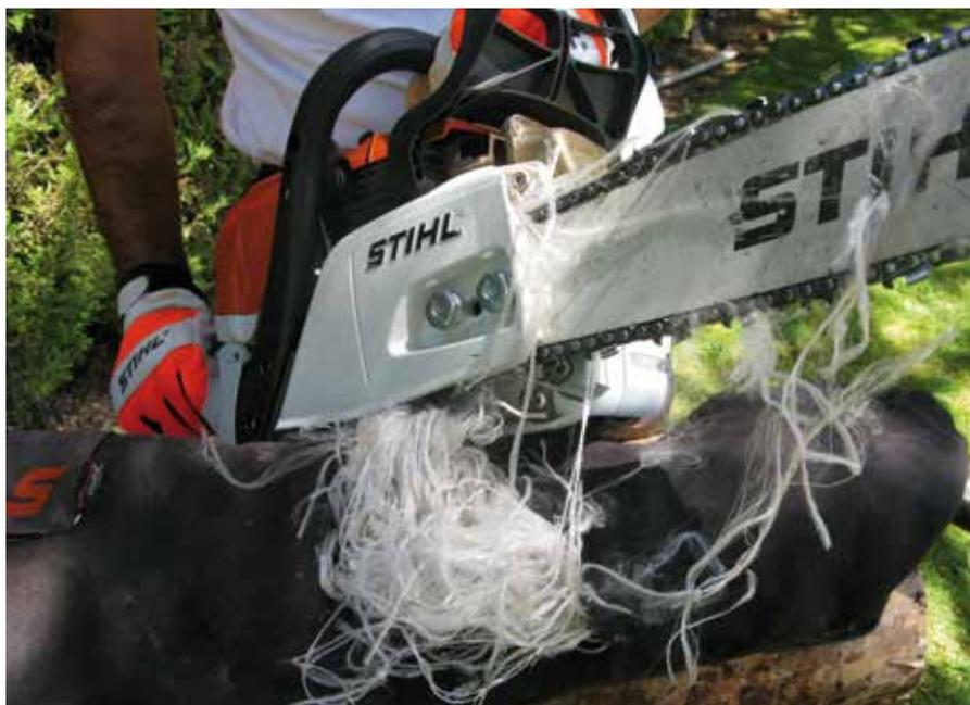
Los E.P.I. para trabajo con motosierra han de llevar unas fibras especiales de material sintético, que protegen al trabajador ante un contacto del equipo de corte. Parán completamente la cadena en milésimas de segundo, aun estando ésta acelerada.
