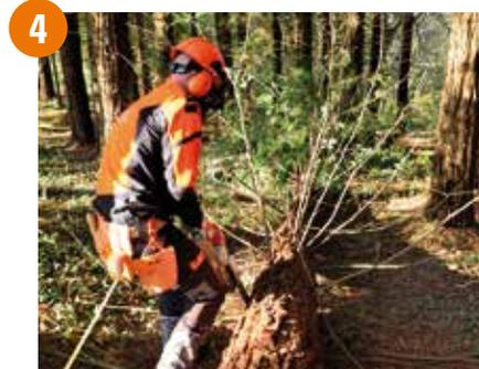
4 Nos desplazamos colocando el freno de cadena, cortamos la rama siguiente de nuestro lado, y en este caso, con la parte superior de la espada.
