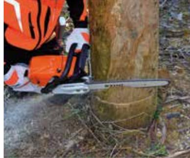
Nos sirve para direccionar la caída del árbol. Consiste en un corte horizontal con una profundidad de entre 1/3 a 1/5 del diámetro del árbol, y un corte inclinado u oblicuo de unos 45°, haciendo que coincidan ambos cortes en el mismo punto. La línea de intersección de estos cortes ha de quedar a 90° de la dirección deseada de caída, para esto nos podemos ayudar de la línea de referencia para el apeo de la motosierra.
