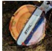
**Corte de abanico por secciones** (Para árboles de diámetros superiores a la espada, hasta un máximo del doble)
