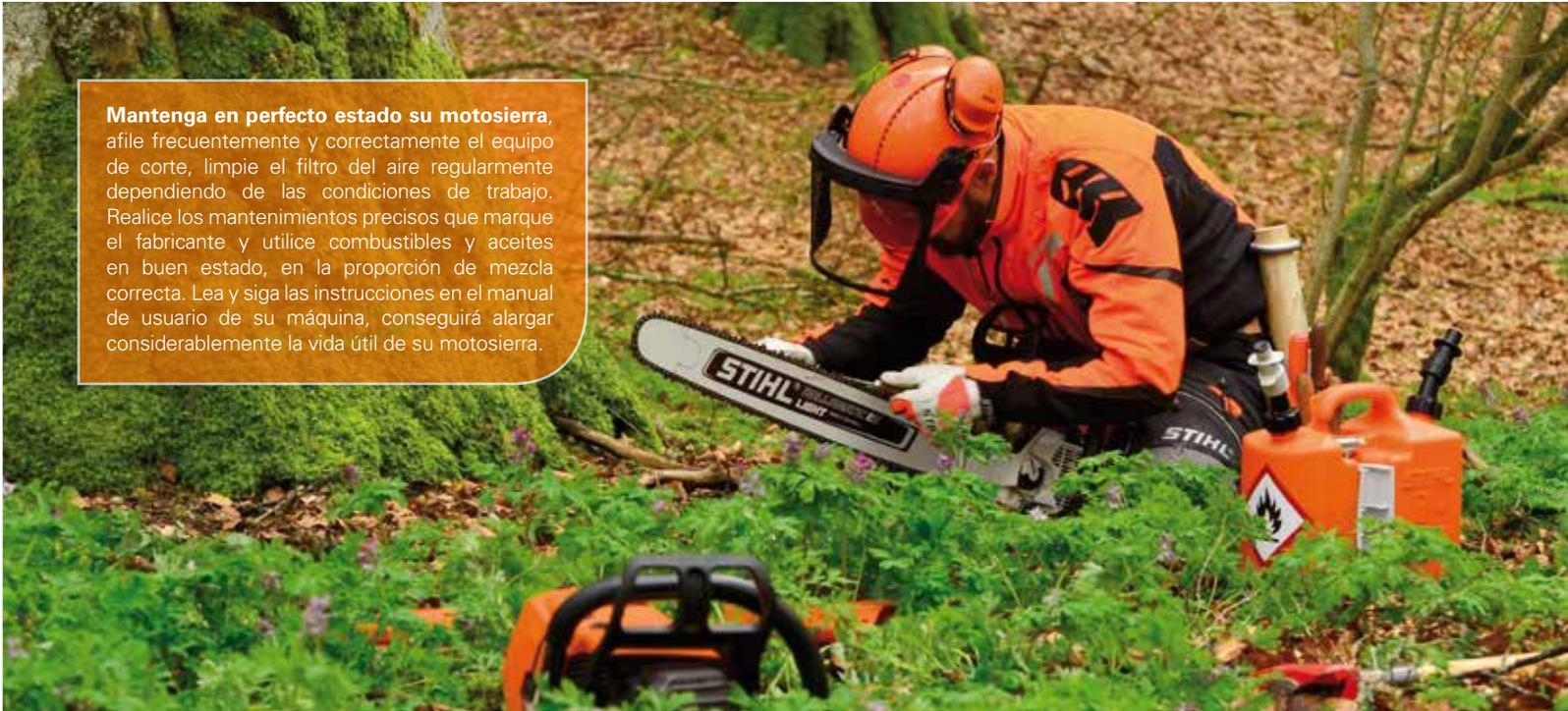
**Mantenga en perfecto estado su motosierra**, afile frecuentemente y correctamente el equipo de corte, limpie el filtro del aire regularmente dependiendo de las condiciones de trabajo. Realice los mantenimientos precisos que marque el fabricante y utilice combustibles y aceites en buen estado, en la proporción de mezcla correcta. Lea y siga las instrucciones en el manual de usuario de su máquina, conseguirá alargar considerablemente la vida útil de su motosierra.
