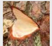
El corte inclinado de la entalladura puede ser modificado a diferentes grados, dependiendo en qué momento queramos que se rompa la bisagra.
