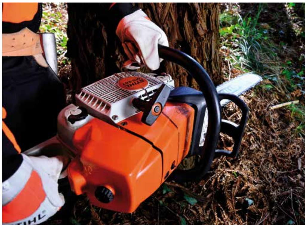
Se debe acelerar con el dedo pulgar cuando se coloca la espada en posición horizontal, por ejemplo, al realizar el corte de talado de los árboles o el desrame de los troncos (al cortar la rama que se encuentra en la parte superior e inferior).
