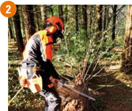
2 Apoyar la espada horizontalmente sobre el tronco y cortar la rama de arriba con la parte superior de la espada.
