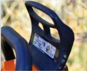
**Freno de cadena.** Consiste en un dispositivo mecánico cuya función es detener en milésimas de segundo la cadena, está diseñado principalmente para evitar lesiones o daños producidos por un posible rebote de la motosierra.
