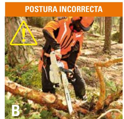
Se debe cortar siempre por el lado de la tensión para evitar que la espada se atasque, en el caso de no saber dónde se encuentra, dar pequeños cortes a un lado y al otro de la rama y terminar cortando por el lado por donde se nos abra el corte.
